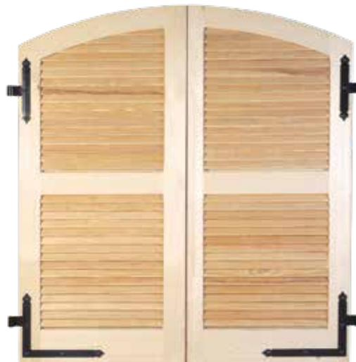
Cadre sapin épaisseur 31/32 mm, lamettes en pin de 10 mm, pentures équerres et espagnolette acier, possibilité de cintre avec traverse haute élargie
