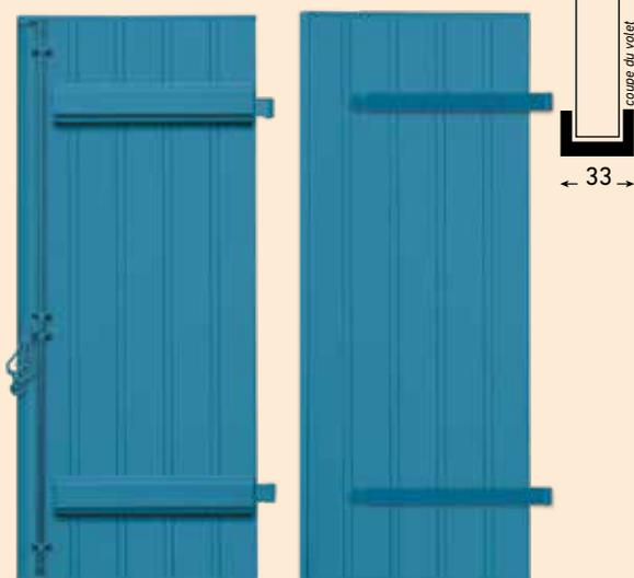
Parois de 2 mm d'épaisseur, renforts métalliques intégrés, barres seules, pentures aluminium, espagnolette tout aluminium. Teinte présentée : bleu 524 (ferrage couleur volet en option)
