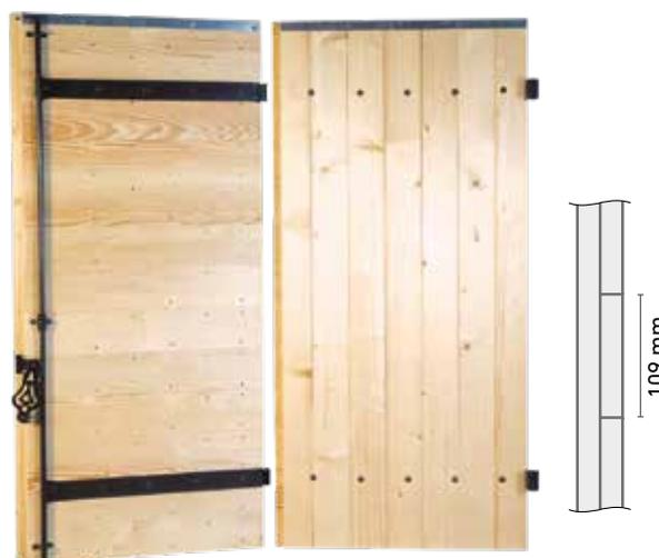
Lames tringlées serties, épaisseur 26/27 mm, lames horizontales 109x20 clouées, pentures coudées section 50x6 mm à bout écrasé, espagnolette pleine à crochets ronds et emboiture haute en zinc
