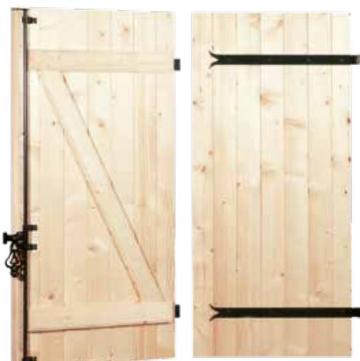
Lames tringlées serties, épaisseur 26/27 mm, barres et écharpes, pentures fixées par vis Torx, pentures et espagnolette acier
