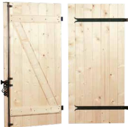
Lames tringlées serties, épaisseur 26/27 mm barres vissées et écharpes, pentures et espagnolette acier.
