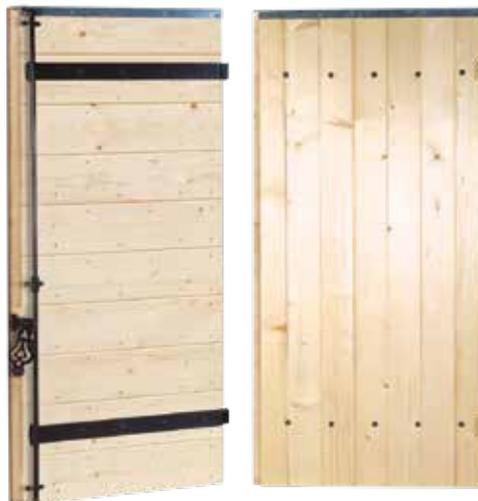
Lames tringlées serties, épaisseur 26/27 mm, lames horizontales 140x20 bouvetées, chanfreinées et clouées, pentures coudées section 50x6 mm à bout écrasé, espagnolette pleine à crochets ronds et emboiture haute en zinc
